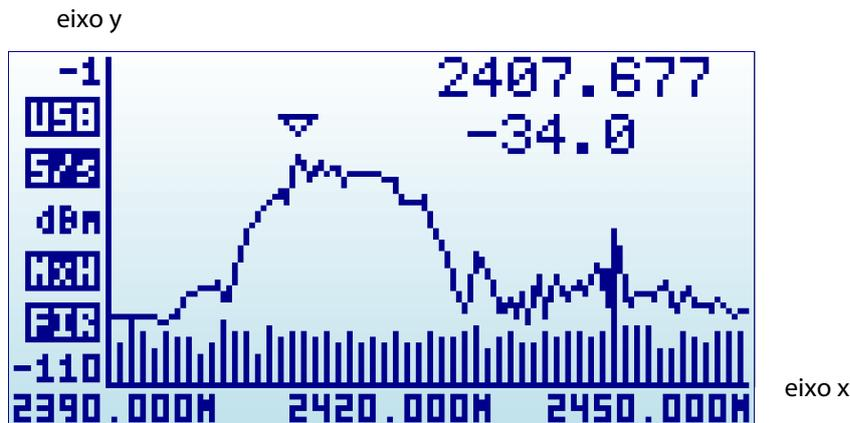
O eixo X representa a frequência em MHz e o eixo Y mostra a potência real recebida em dBm ou dBuV (selecionável).
