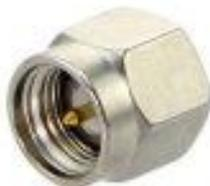
A utilização de terminação SMA ou de uma Carga é recomendada para proteção da porta SMA do analisador quando o dispositivo for exposto a radiações indesejadas ou campos electrónicos fortes. Por exemplo, se o analisador ficar exposto em um scanner de raio-X no aeroporto, deve-se remover a antena e conectar uma terminação SMA de 50 Ohms.
